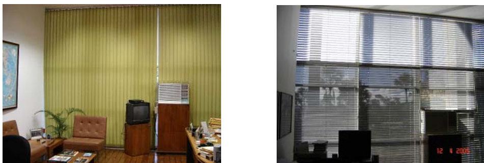
Figura 4: Sala original com persianas em tecido (esquerda) e sala protótipo com modificações propostas (persianas aluminizadas perfuradas, prateleira de luz e película de controle solar).
