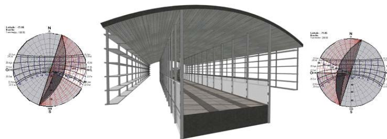
Figura 3: Passarelas ventiladas e cobertura para proteção solar (veja mascaras de sol)
