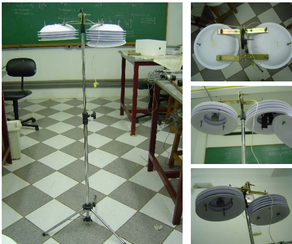
Figura 03: Tripé com as proteções fixados
