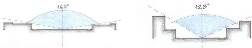
Figuras 15 e 16 - Fator de visão do céu - Cortes longitudinal e transversal da praça.
