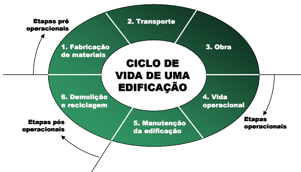
Figura 1: Ciclo de vida de uma edificação
