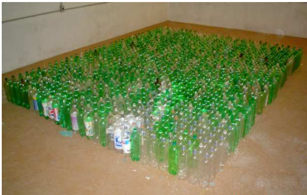
Figura 1 – Garrafas “pet” inteiras, dispostas para ensaio na câmara reverberante.
