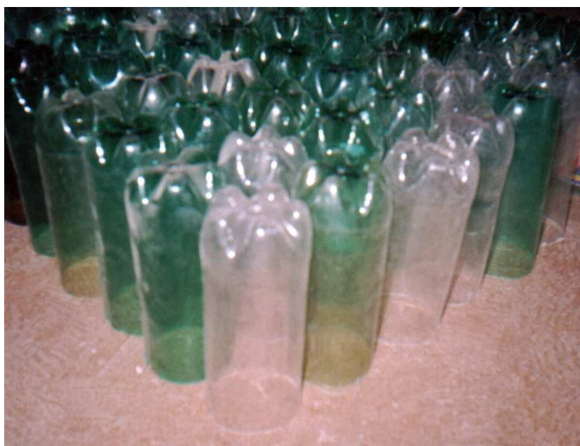
Figura 2 – Garrafas “pet” cortadas e com a abertura voltada para baixo, dispostas para ensaio na câmara reverberante.
