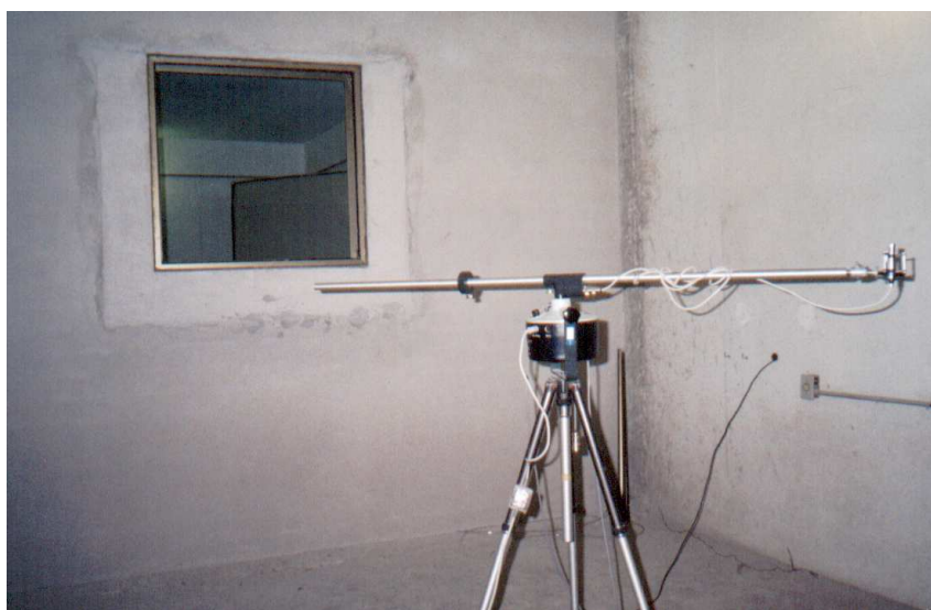
Figura 1 – Parede de alvenaria que divide as salas de emissão e recepção, com caixilho fixo para a colocação dos vidros testados.
