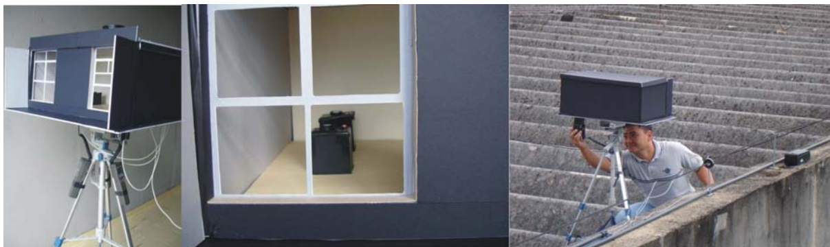
Fig. 03- Modelo Reduzido e medições com luxímetro, sensor LDR e fotodiodo
