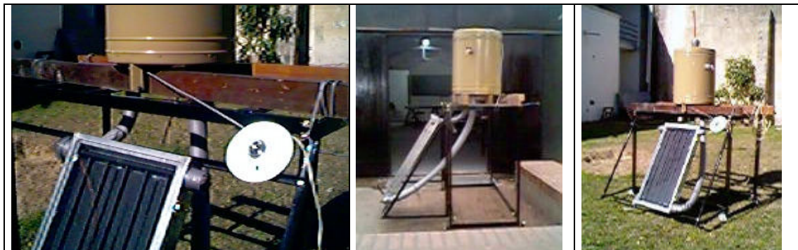
Figura 8. Banco de pruebas móvil (Probeta, solarímetro, acumulación, adquirentes de datos). FAU-UNLP.
