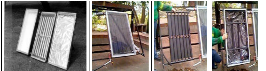
Figura 7. Realización de “probetas”. Polietileno con acoples M-M. Polipropileno roscado. Bolsa de PVC
