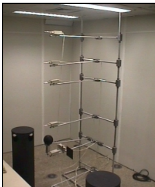
Figura 3 – Sistema de aquisição de dados no ambiente e “simuladores”
