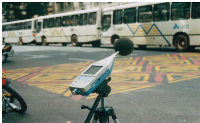
Figura 2: Foto do sonômetro NA-27 num ponto de medição (Foto: Elcione Moraes).
