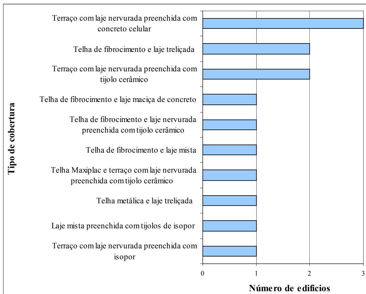
Figura 8 - Tipos de coberturas utilizadas em 14 edifícios privados de escritório.
