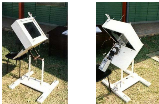
Figura 2 e Figura 3. Vista frontal e posterior da bancada em operação. Fonte: Pereira et al., 1999.
