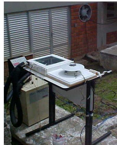
Figura 10. Configuração geral da medição utilizando o resfriamento por circulação de água.
