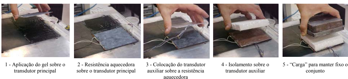
Figura 7. Seqüência do processo de calibração dos transdutores.
