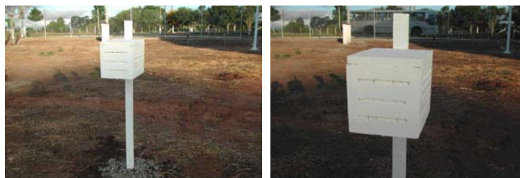
Figura 3: Abrigo utilizado para medição da temperatura externa
