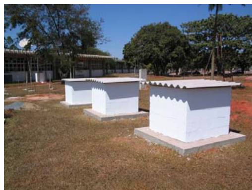
Figura 3 - Test-cells com pintura externa de cor branca
