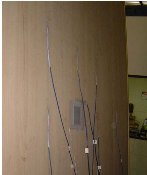
Figura 5 - Termopares e fluxímetro em amostra de madeira
