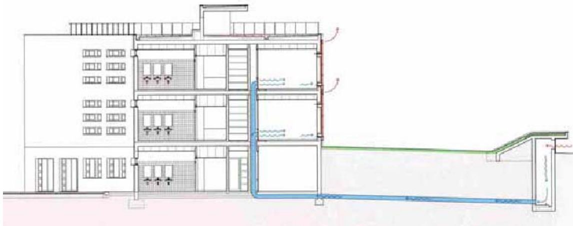
Fig. 13. Localização dos tubos enterrados.
