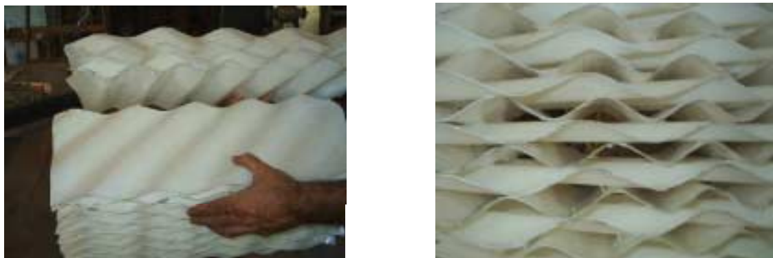
Figura 2: Relleno estructurado construido con secciones de chapa ondulada plástica
