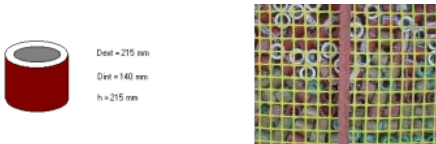
Figura 5: Relleno aleatorio con secciones de caño de PVC
