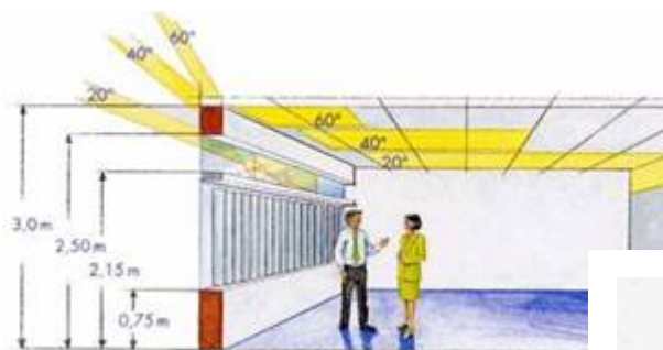
Fig.13: Plexiglas colocado na parte superior da janela – luz difusa direcionada para o fundo da edificação. Croquis esquemáticos: comportamento da luz nos sistema fixado na vertical e horizontal.
