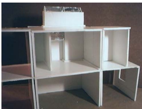
Figura 1. Solução I: vista da maquete da moradia (esc 1:20) com os dutos e a clarabóia na cobertura.
