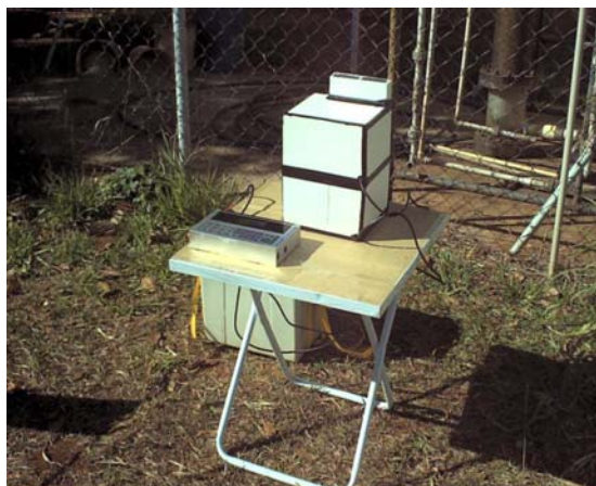
Figura 7. Protótipo da Proposta I, com a posição dos sensores. Sensor 1: pavimento térreo. Sensor 2: pavimento superior. O modelo foi fotografado sem a parede da face do norte geográfico, para visualização dos sensores fotométricos.
