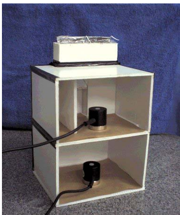
Figura 7. Protótipo da Proposta I, com a posição dos sensores. Sensor 1: pavimento térreo. Sensor 2: pavimento superior. O modelo foi fotografado sem a parede da face do norte geográfico, para visualização dos sensores fotométricos.
