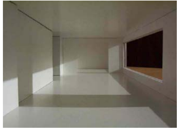
Figura 2b. Ensayo en el Heliodón, interior de la sala de estar, invierno a las 15 horas.
