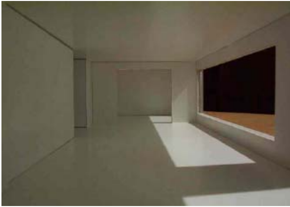
Figura 2a. Ensayo en el Heliodón, interior de la sala de estar, equinoccio a las 14 horas.
