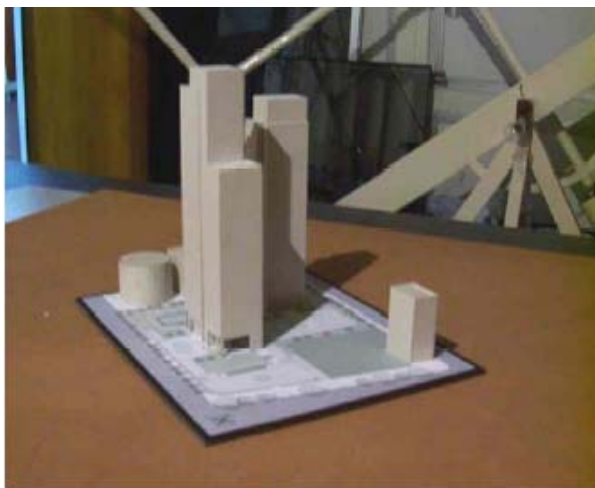
Figura 1a. Ensayo en el Heliodón con maqueta del conjunto.
