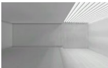
Fig. 5: Aspecto da iluminação natural produzida na sala leste, no dia 22/06 às 9 h. Altura das lâminas = 20 cm.
