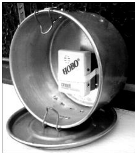
Figura 1: Registrador Hobo e sua proteção
