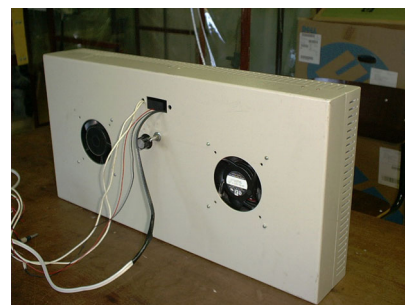
FIGURAS 2 e 3: Configuração final do transdutor do Radiômetro de Abertura desenvolvido na UFSC.
