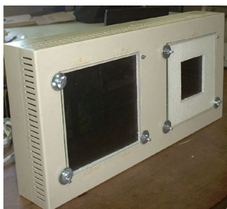
FIGURAS 2 e 3: Configuração final do transdutor do Radiômetro de Abertura desenvolvido na UFSC.
