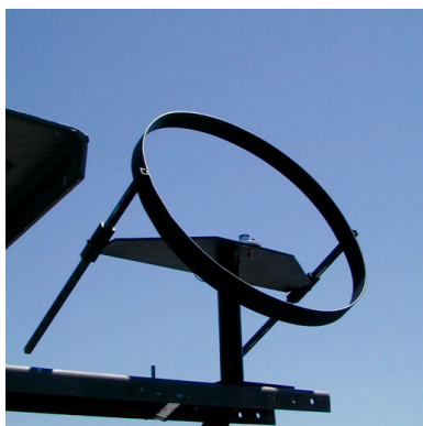
Figura 5. Anel de sombreamento para medição de radiação difusa.
