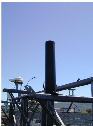
Figura 16. Tubo colimador para medição de luminância de céu.
