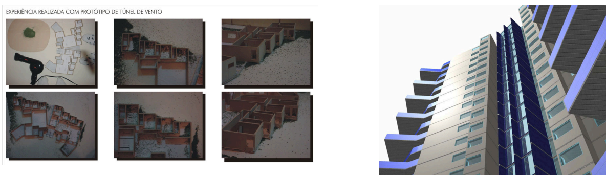
Figura 1 – Ensaio de erosão e perspectiva do edifício.
