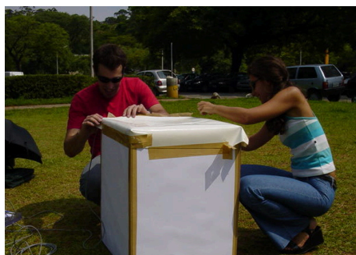
Figura 8 – Ensaio de transmissão de luz e calor pela cobertura têxtil.
