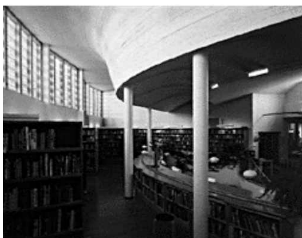
Figura 3: Interior da biblioteca mostrando o forro curvo que reflete e distribui a luz natural na área das prateleiras (Fonte: http://www.jkl.fi/aalto/ ).
