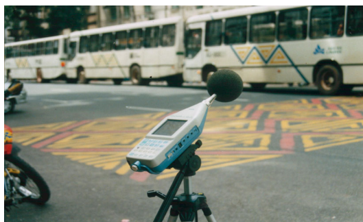
Foto 01: Detalhe do sonômetro num ponto de medição. Foto Elcione Moraes
