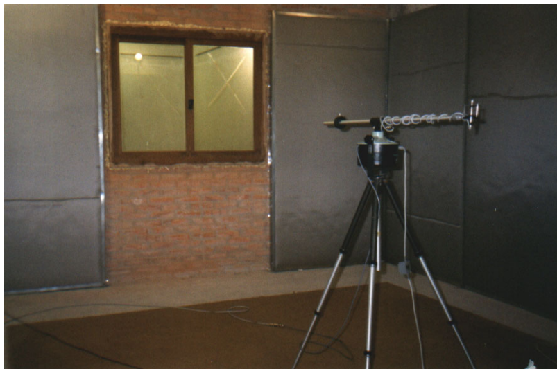
Figura 2 - Foto do interior da câmara de recepção com os painéis absorventes
