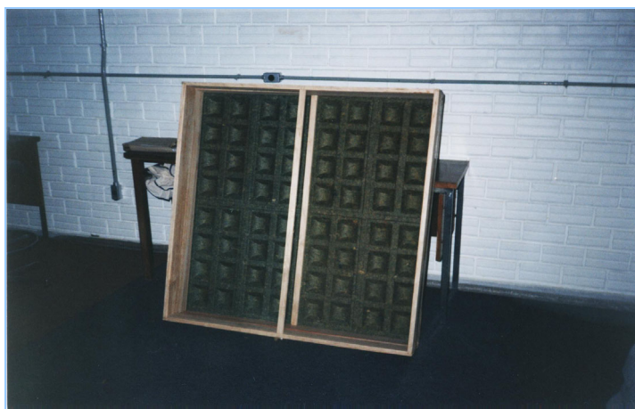
Figura 3: Painéis de Feltro Automotivo – Montagem para Ensaio de Absorção Sonora
