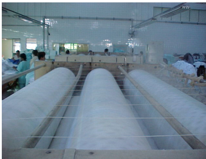
Figura 2- Calandra de secar e passar roupa, sem exaustor.
