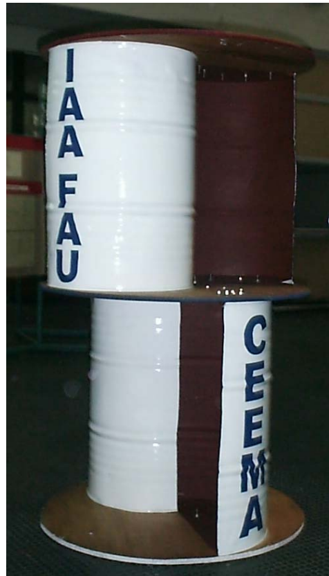
Fig. 3: Turbina Savonius construída por el CEEMA- IAA-FAU- UNT.
