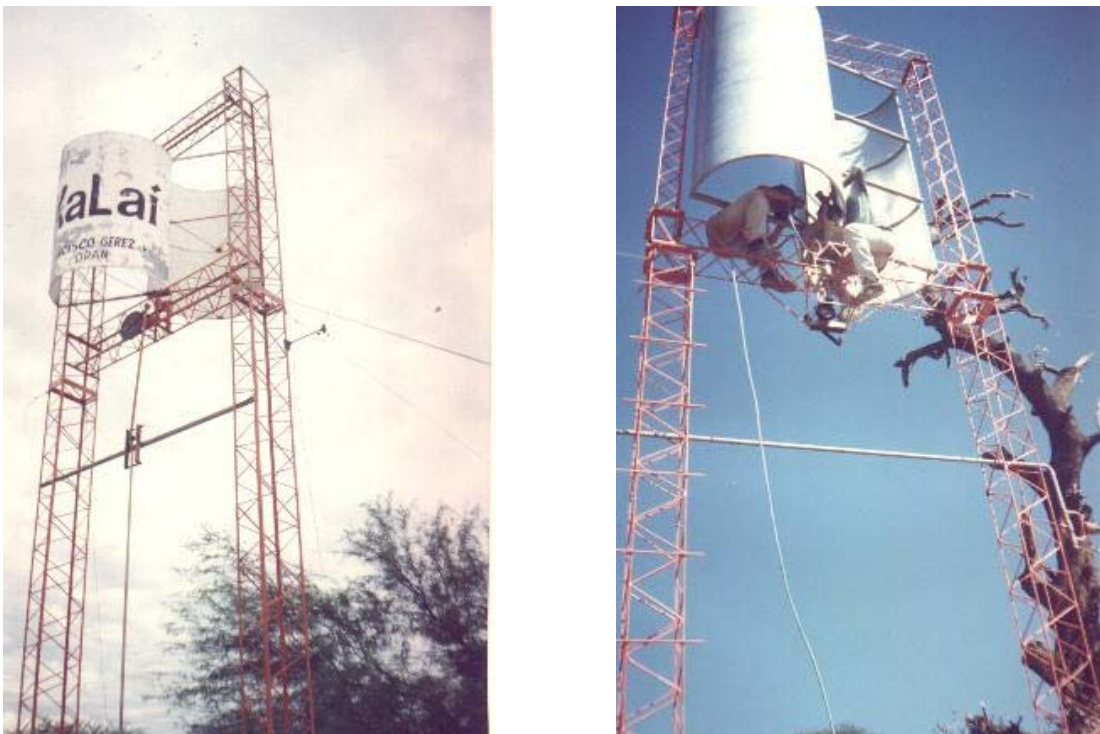
Fig. 1: Turbina Savonius y estructura portante de filigrana del aerobombeador Kalaí. Sistemas instalados en las localidades de las Vertientes y Sta. Victoria Este (Salta)
