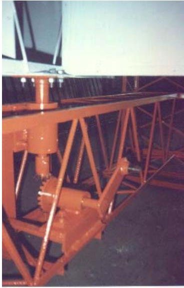
Fig. 2: Mecanismo de transmisión empleado. La corona y el piñón del aerobombeador provienen del reciclado del diferencial de un automóvil. La relación de desmultiplicación entre los engranajes y el largo de la manivela se ajustan según las características aerológicas del lugar de emplazamiento y las particularidades del proyecto hidráulico
