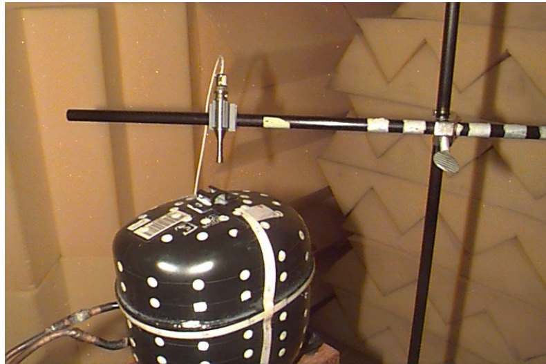
Figura 6. Medidas de sinais sonoros emitidos por compressor hermético
