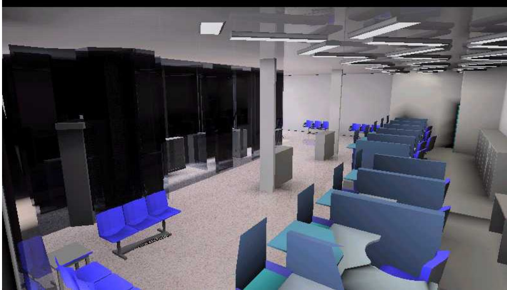
Figura 11 - Aspecto da agência bancária simulando apenas com as luminárias necessárias.
