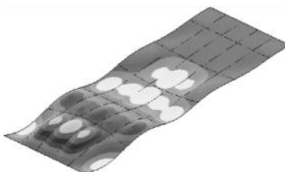
Fig. 3 - Modo de Vibração Correspondente à Segunda Freqüência Natural (10,68 Hz)
