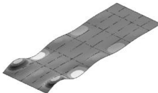
Fig. 2 - Modo de Vibração Correspondente à Primeira Freqüência Natural (10,31 Hz)
