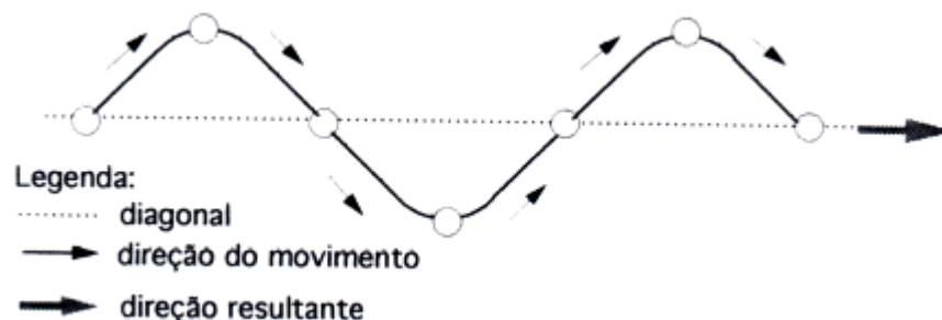
Figura 3, arredondamento dos vértices do desenho do percurso triangular.
