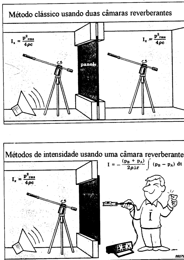
Figura 9: Medição de transmissão; método clássico com duas câmaras reverberantes e com técnica de intensidade
