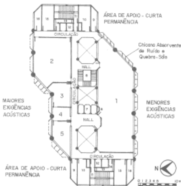
FIGURA 2: Planta do Pavimento-Tipo e Programa Funcional.
